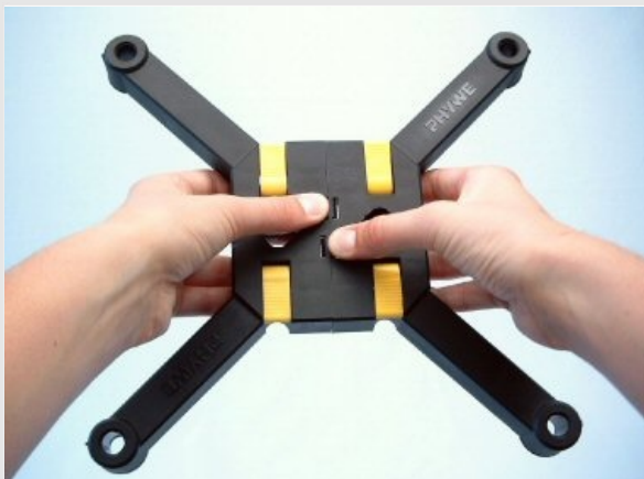
Desmontando la base del trípode
